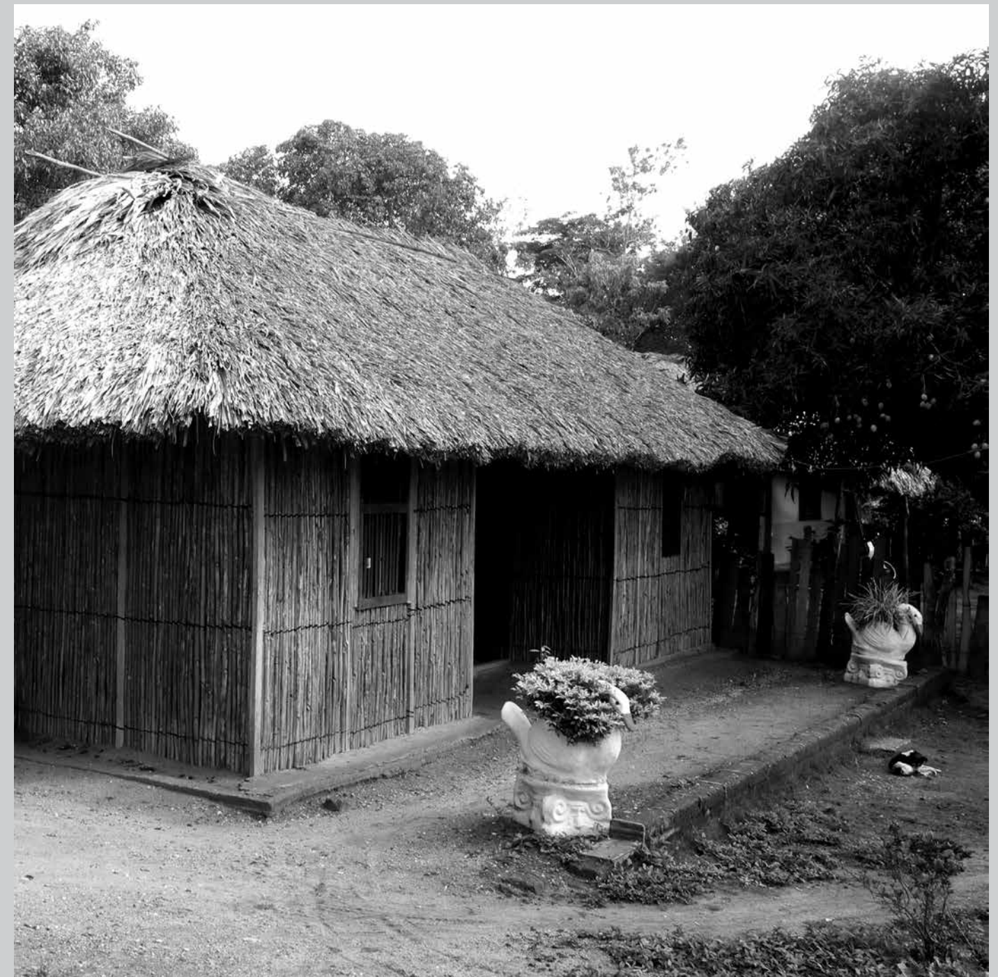
Casa con aterrado, muros en caña-lata y techo en palma amarga peluquiada. Municipio de Cereté, Córdoba.
