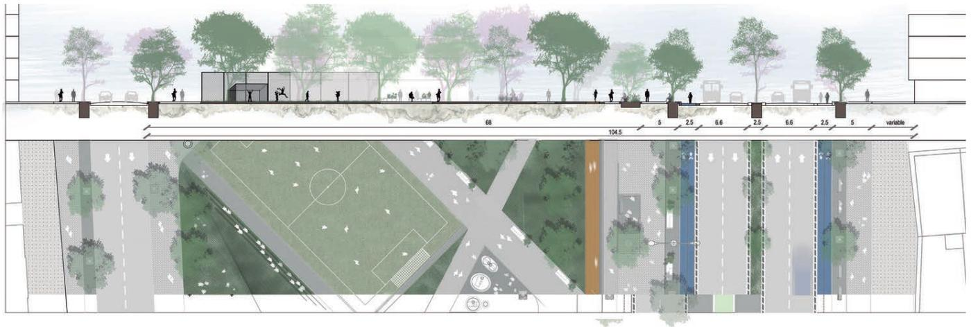
Para lograrlo, se proyecta un nuevo perfil en la carrera 114, aprovechando el área libre en desuso e implementando una vía en doble sentido, con un andén amplio y ciclorruta del lado oriental, y un parque lineal en el costado occidental.
